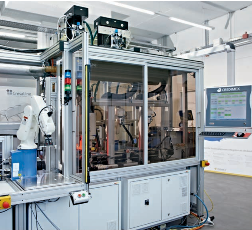
Bei dieser Cresaline-Ausführung verbindet XTS fünf Prozessstationen.
