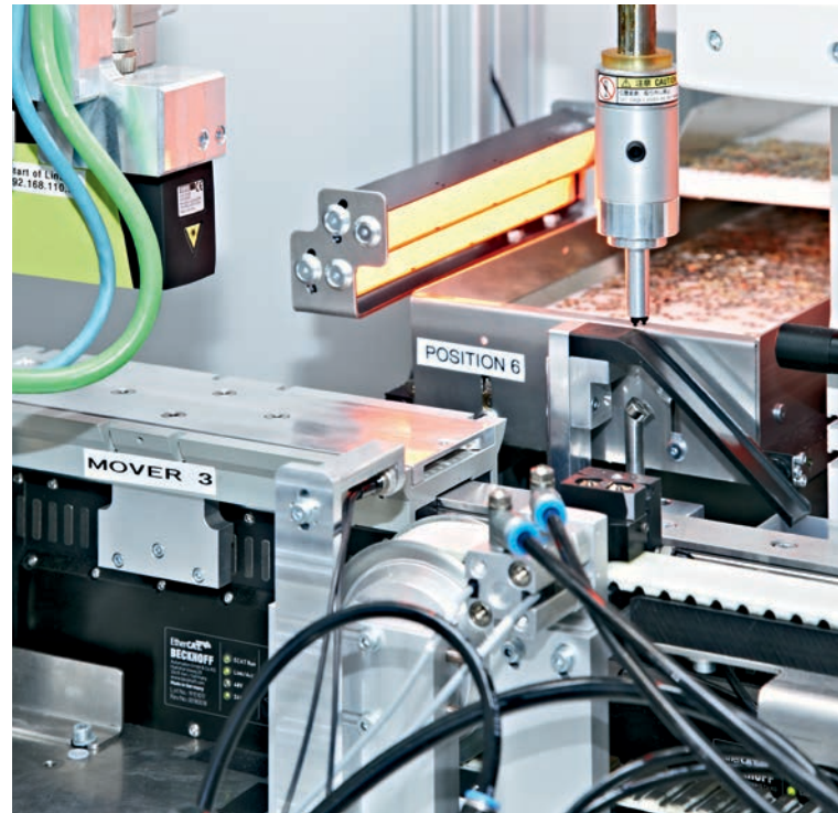
Die Entkopplung von Transfersystem und Prozessstationen ist bei der Montage von Kleinteilen von besonderer Bedeutung.
