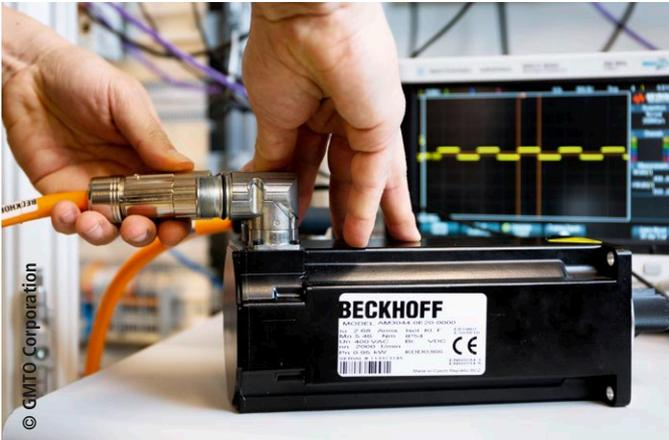
Die Servomotoren AM8000 von Beckhoff sind in der gesamten Teleskopkonstruktion für die Bewegung von mehr als 3.000 Achsen vorgesehen.
