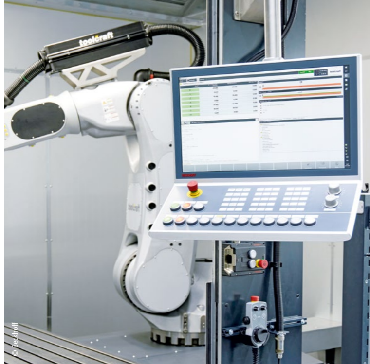
Bedienung bzw. Bahnplanung erfolgen auf dem kundenspezifischen Multitouch-Control Panel CP3921 wie bei einer 5-Achs-CNC in G-Code.
