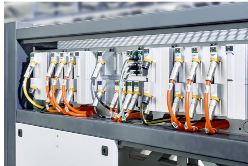
Zweireihige Baseplate des MX-Systems: Die offene Montage an den Grundgestellen vereinfacht die Verkabelung der Maschine und erleichtert die Diagnose.
