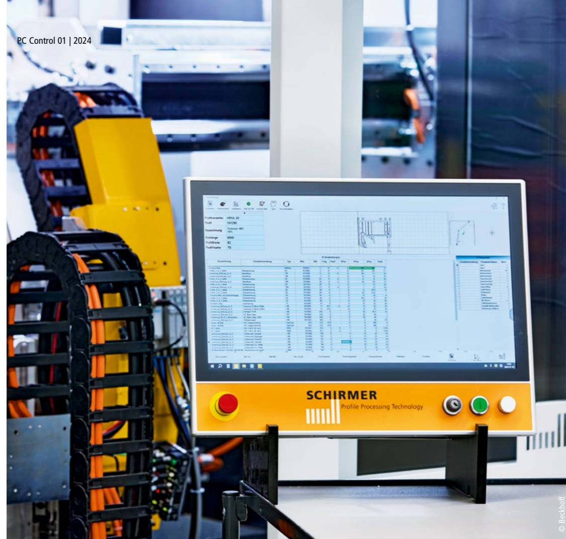
Die komplette Maschine wird über ein kundenspezifisches Beckhoff Control Panel eingerichtet und bedient.
