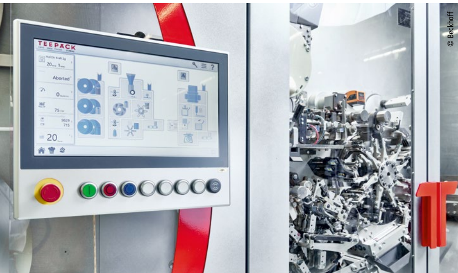
Das Multitouch-Control-Panel CP39xx mit Tastererweiterung ermöglicht ein optimales Bedienen und Beobachten der Maschinenabläufe.
