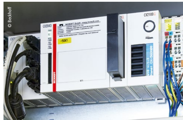
Dynamische Synchronisation sämtlicher Achsen, Safety, HMI und individuelle Datenbank-Applikation – das komplette Automatisierungsprojekt läuft auf einem einzigen Embedded-PC CX2043.
