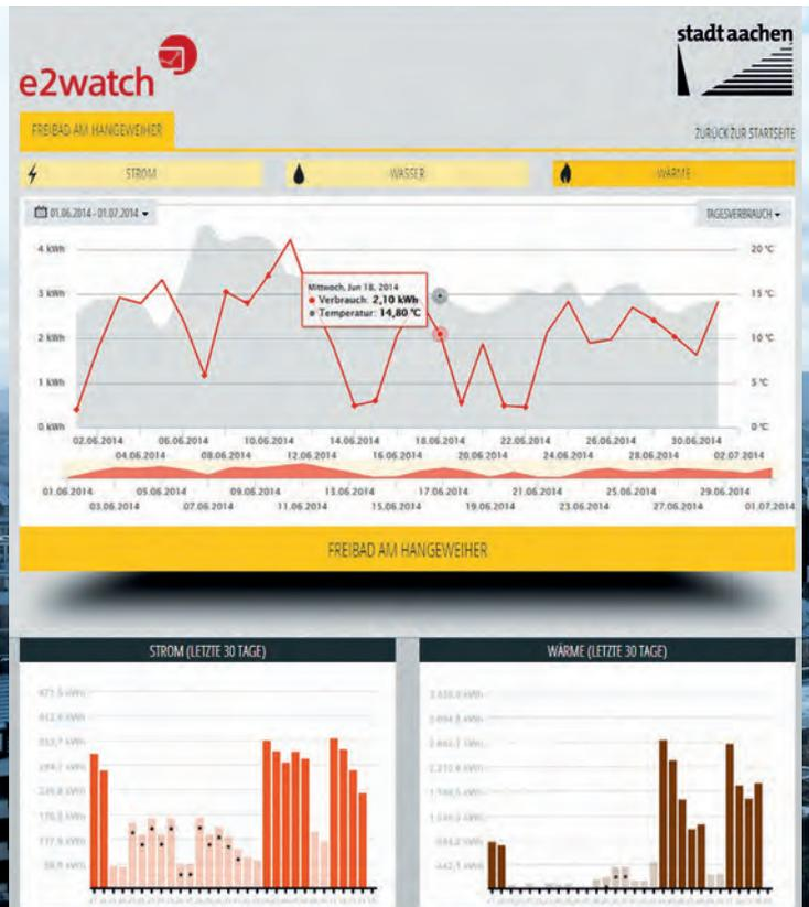
Mit dem Monitoringsystem e2watch lassen sich die in der Cloud gespeicherten Energiedaten komfortabel analysieren.
