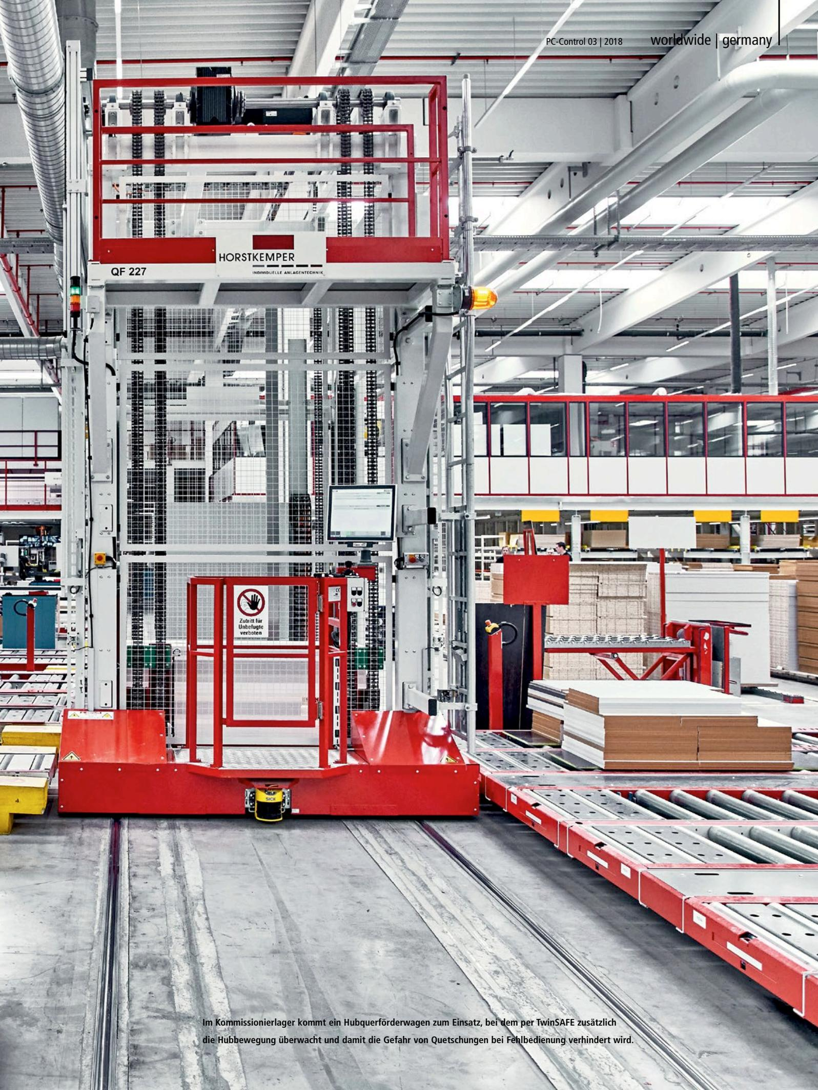
Im Kommissionierlager kommt ein Hubquerförderwagen zum Einsatz, bei dem per TwinSAFE zusätzlich die Hubbewegung überwacht und damit die Gefahr von Quetschungen bei Fehlbedienung verhindert wird.
