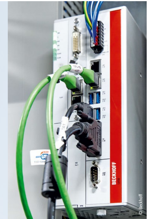
Die Bahnsteuerung und Koordination aller Achsen erledigen TwinCAT und ein Schaltschrank-Industrie-PC C6930.
