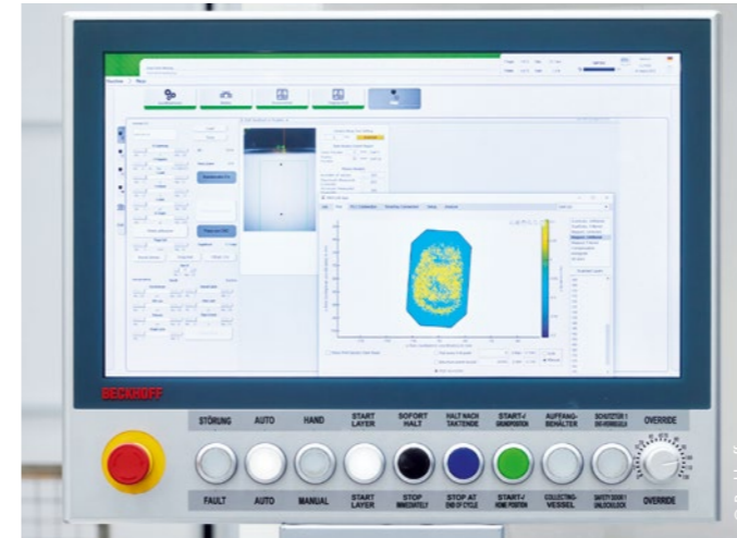
Das kundenspezifische Multitouch-Control-Panel CP3918 unterstützt die optimale Bedienbarkeit der GMP300.
