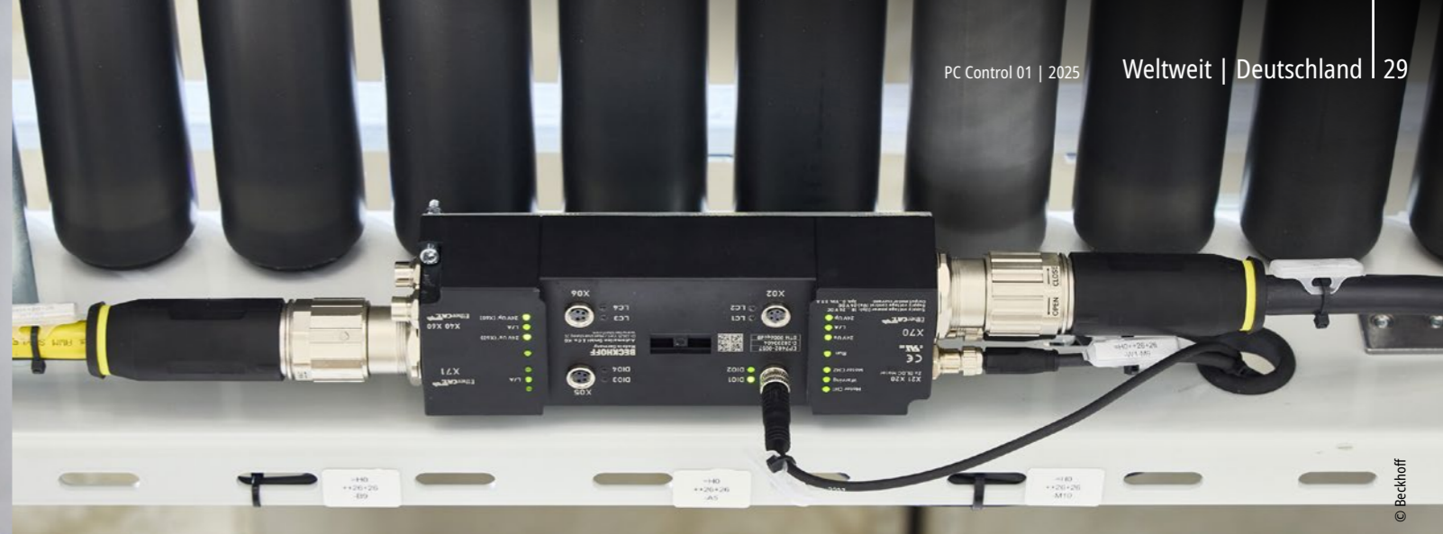
Spezielle Komponenten wie Barcode-Scanner werden über den integrierten EtherCAT-Abzweig der MDR-Controller eingebunden.
