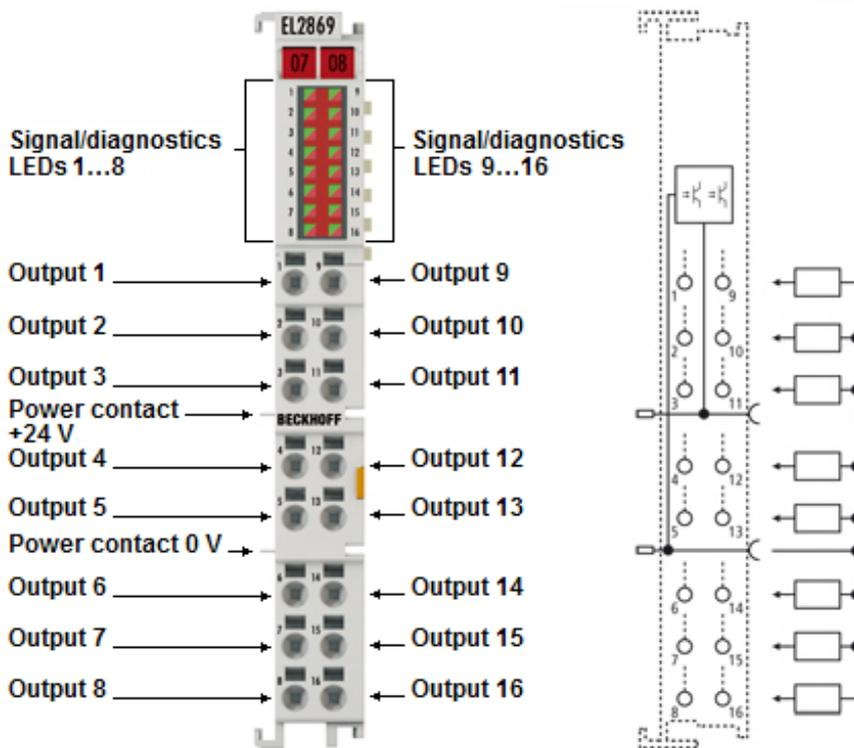
**EL2869 | HD-EtherCAT-Klemme, 16 digitale Ausgangskanäle, 24 VDC, 0,5 A, mit kanalweiser Diagnose**
