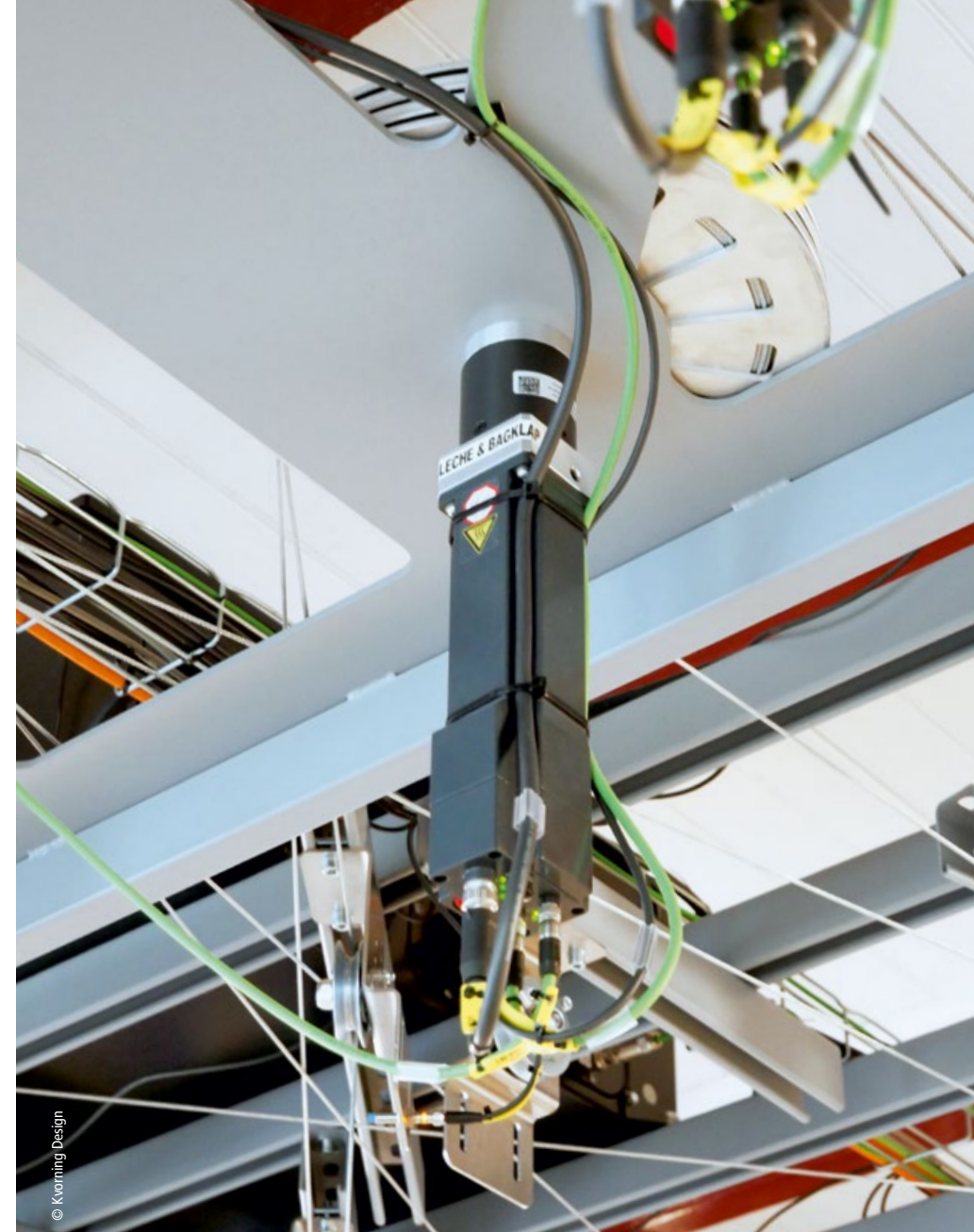
Dezentrale Servoantriebe AMI8100 mit spielfreier Permanentmagnet-Haltembremse und TwinSAFE-Sicherheitsfunktion STO/SS1 bewegen die kleineren Karosserieteile – über TwinCAT geregelt synchron zu den Servomotoren AM8000.
