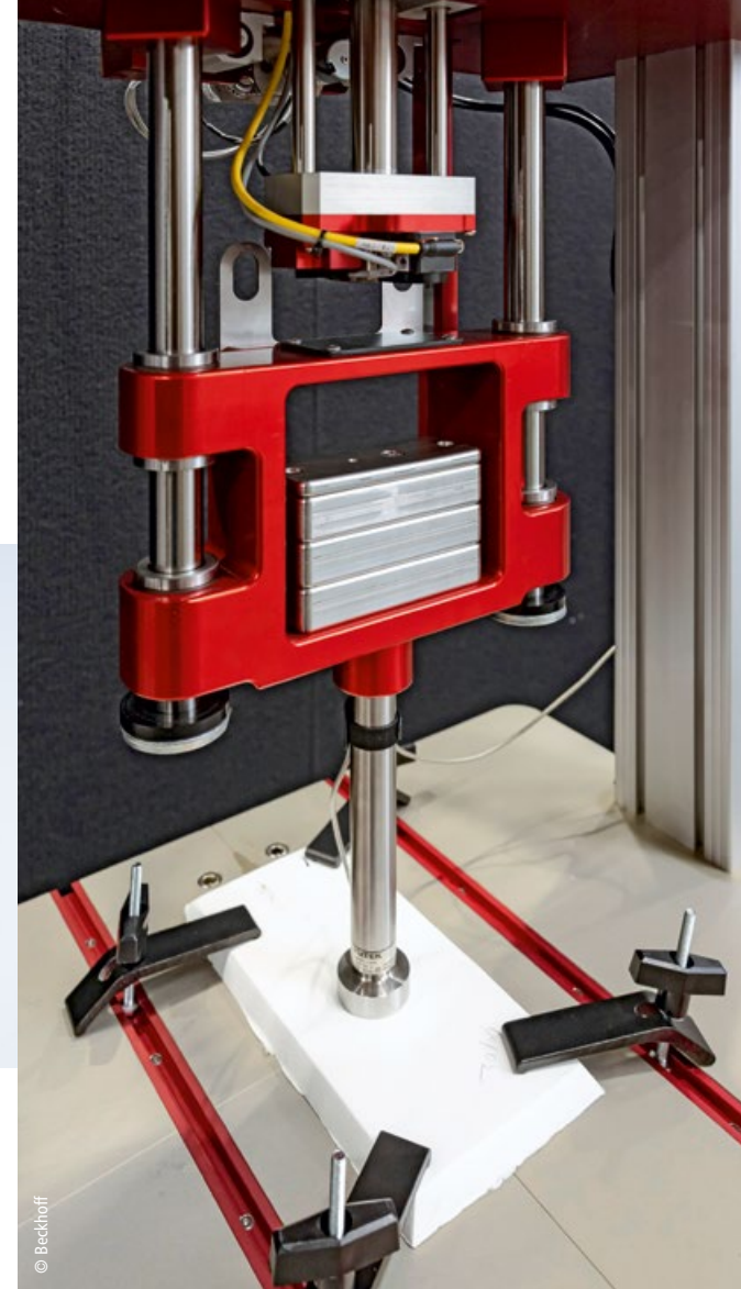
Die EtherCAT-Kommunikation sichert durch die exakte Synchronisierung von Last und Position die Integrität der Testdaten.
