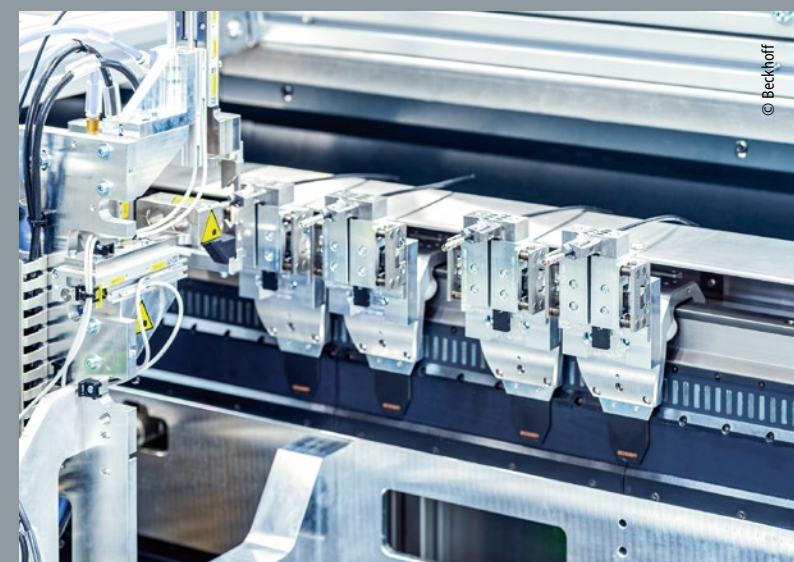
Die Mover des linearen Transportsystems XTS bewegen die über mechanische Greifer fixierten Kabel hochflexibel und mit geringem Platzbedarf zu den verschiedenen Prozessmodulen.
