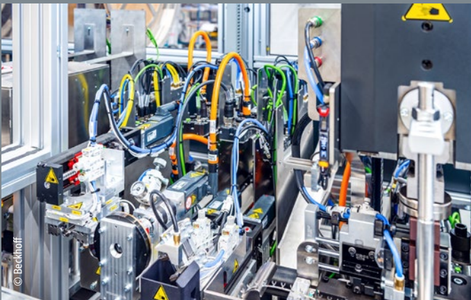
Die kompakte Antriebstechnik von Beckhoff kommt bei der Lambda X als Servomotor-EtherCAT-Box-Module EP7211 und Servomotoren AM8100 zum Einsatz.
