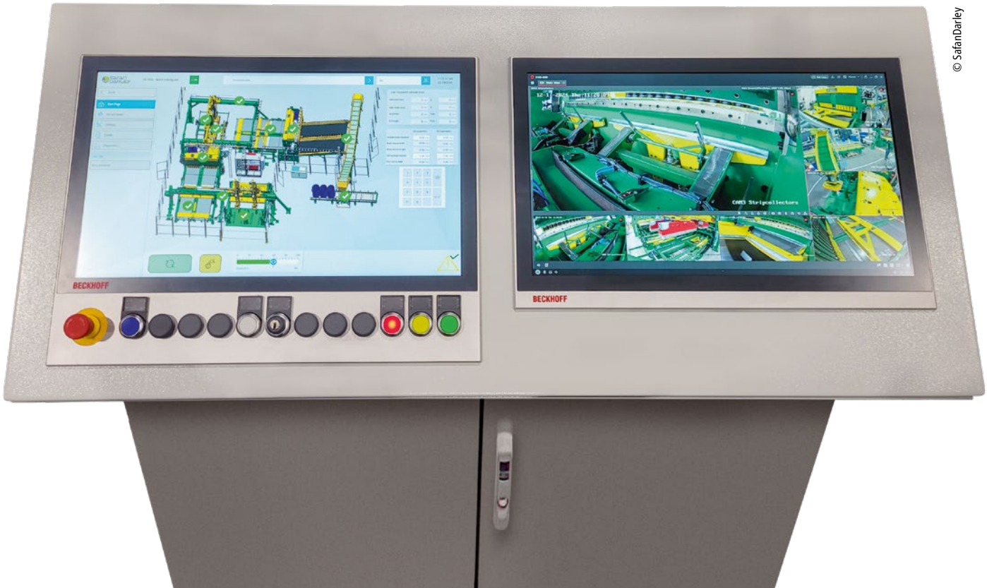
Steuerkonsole mit einem Beckhoff Multitouch-Control-Panel CP29xx mit kundenspezifischen Tastererweiterungen (l.) und einem zweiten CP29xx für die Live-Bilder zur Überwachung kritischer Anlagenteile (r.)
