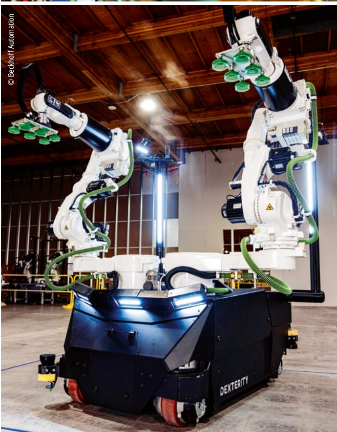
Oben: Der Roboter kann gemischte Ladungen mit Kartons unterschiedlicher Größe be- und entladen, denn die physische KI verleiht ihm Seh- und Tastsinn.
