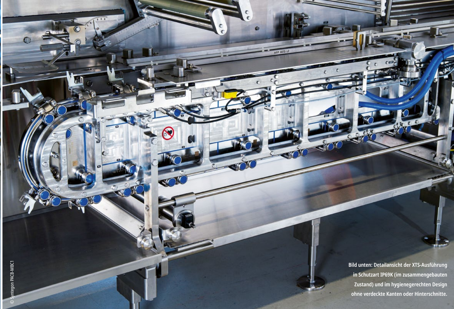
Das lineare Transportsystem XTS in der Hygienic-Ausführung bildet das zentrale Handlichelement der horizontalen Schlauchbeutelmaschine in Washdown-Ausführung von Syntegon.
