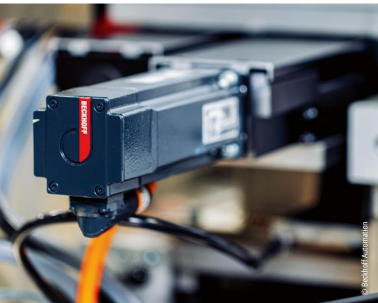
Die Servomotorklemmen ELM7212 steuern über Servomotoren AM8100 die Positionierung der Druckköpfe, um eine gleichmäßige Überlagerung mehrerer Tintenfarben zu gewährleisten.
