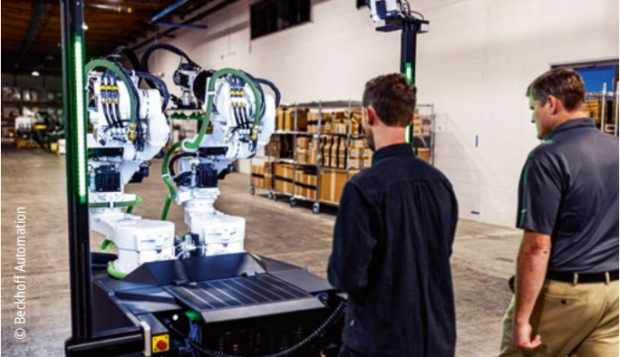
Das ultrakompakte Fahrgestell des Mech verfügt über vier lenkbare Räder, mit denen er sich bewegt, dreht und Rampen erklimmt.
