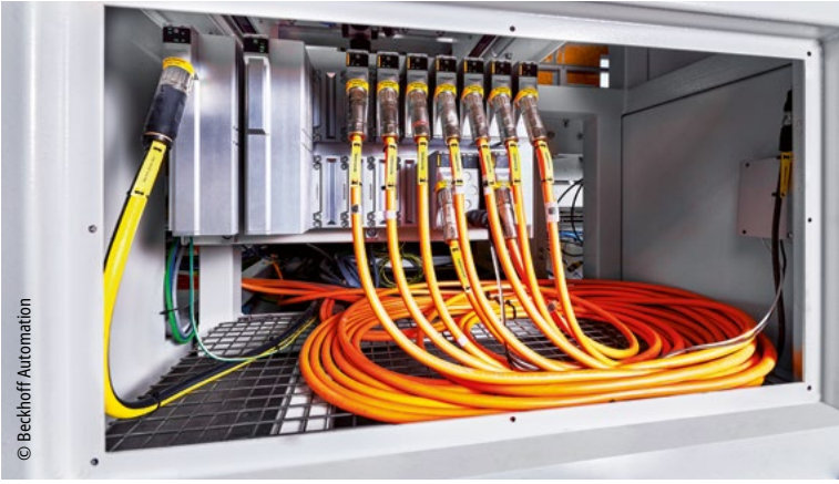
Das MX-System im unteren Teil der Maschine sorgt unter anderem für einen reibungslosen Transport der mit Pulverlack gefüllten Kartons durch die Anlage.
