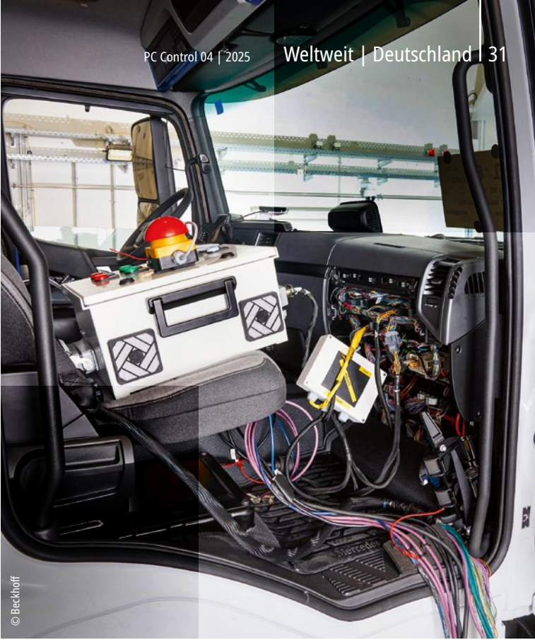
Über einen fahrzeugspezifischen Adapterkabelsatz wird eine kompakte Steuerbox mit der Fahrzeugelektronik verbunden, die mit TwinCAT modifizierte CAN-Botschaften erhält und in die Fahrzeugkommunikation einschleust.
