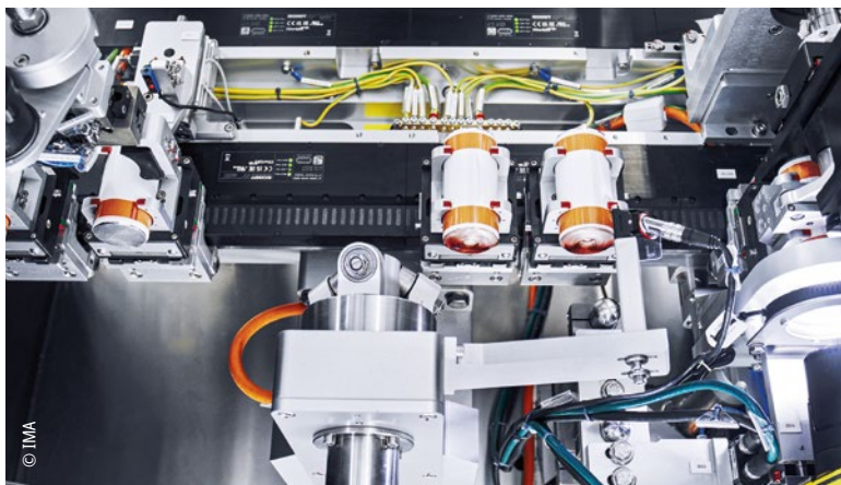
Transport der auf den XTS-Movern befestigten Batteriezellen von einer zur nächsten Montagestation
