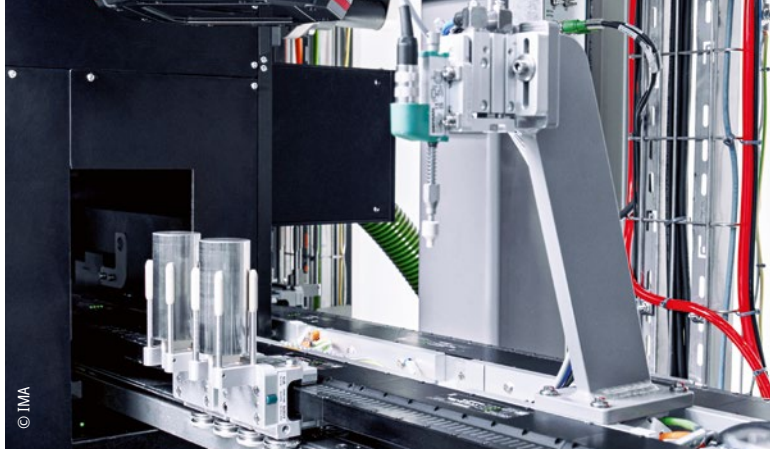
Einfahrt der montierten Batteriezellen in eine Prüfstation
