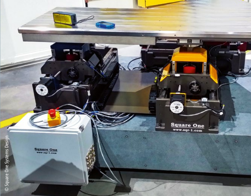
Das hochpräzise Positioniersystem des Roboters Tri-Sphere sorgt dafür, dass er Forschungsgeräte präzise in Strahlen mit einem Durchmesser von nur 100 nm bewegen kann.
