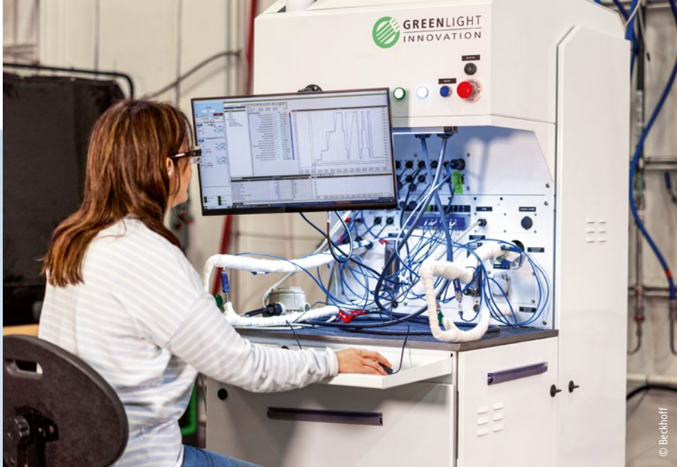
Die Elektrolyseur-Teststation von Greenlight dient der Bewertung und Validierung von Leistung, Langlebigkeit und Effizienz.
