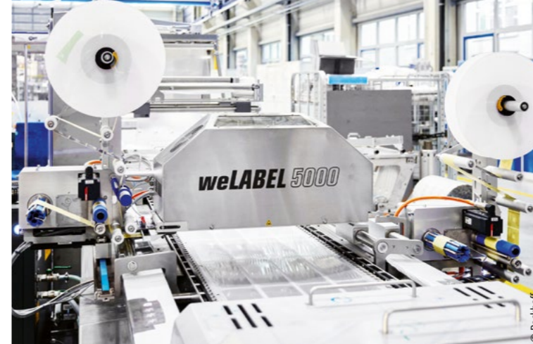
Die Verpackungsmaschinen lassen sich flexibel und bedarfsgerecht mit bis zu vier weLABEL-Etikettierern (hier ein Ober- und ein Unterbahner) ausstatten.
