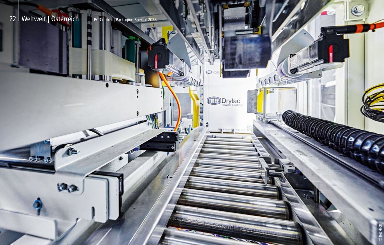
Die Anlage führt verschiedene Prozessschritte vollautomatisch durch – vom Verschließen des Innensacks über das Verkleben des Kartons, Wiegen und Etikettieren bis zur Palettierung.
