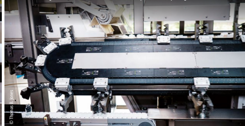
Je ein Mover des oberen und unteren XTS-Systems des vorgeschalteten Zuführungssystem Pickfeeder ergeben den Greifer für den Behältertransport zur Luftspülung.
