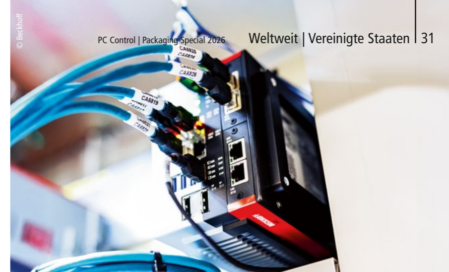
Der Ultra-Kompakt-Industrie-PC C6032 bietet eine hohe Rechenleistung bei minimalem Platzbedarf im Schaltschrank.
